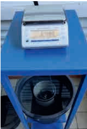
Рис. 4. Гидростатическое взвешивание для определения объемной плотности образцов
