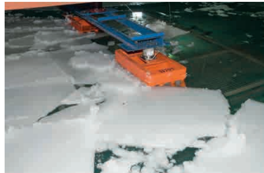
Рис. 3. Экспериментальное исследование нагрузок торосов на опоры Крымского моста
