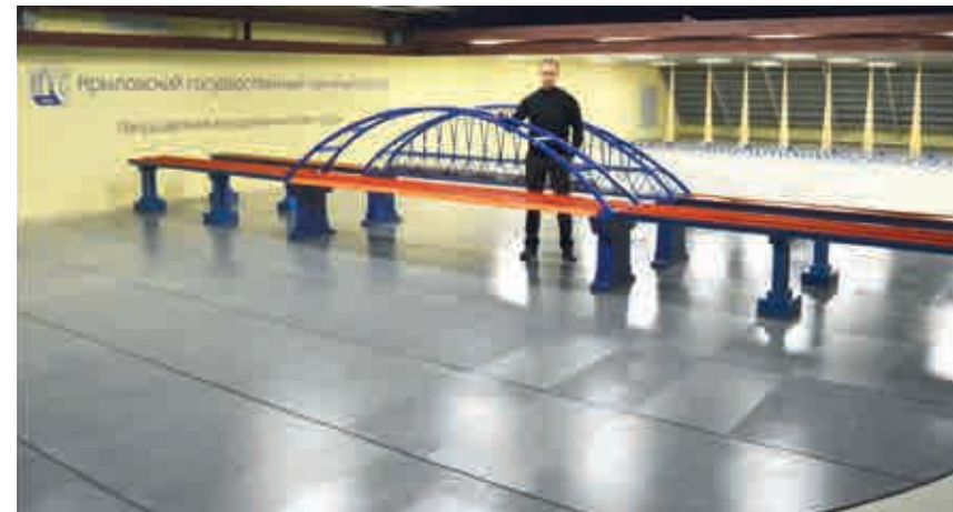
Рис. 1. Модель Крымского моста в рабочей части Ландшафтной аэродинамической трубы
