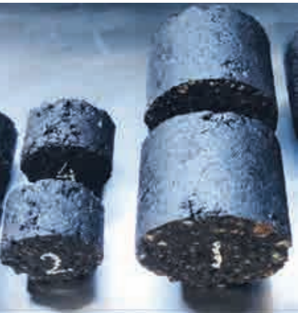
Рис. 3. Внешний вид образцов: 1 — гиратор: масса образца 5 кг, однородный; 2 — Маршалл: масса образца 1,2 кг, неоднородный
