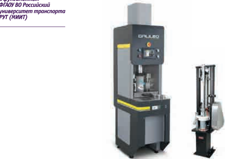
Рис. 1. Гираторный (вращательный) уплотнитель и компактор Маршалла (справа)
