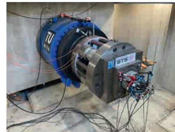
Рис. 2. Испытание вантового пучка СТС на выносливость
