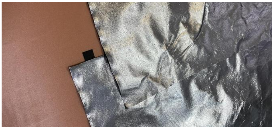
Рисунок 7. – Внешний вид «Контролит ПП» для формирования контрольного разделительного слоя Контролит под водоизоляционным ковром
