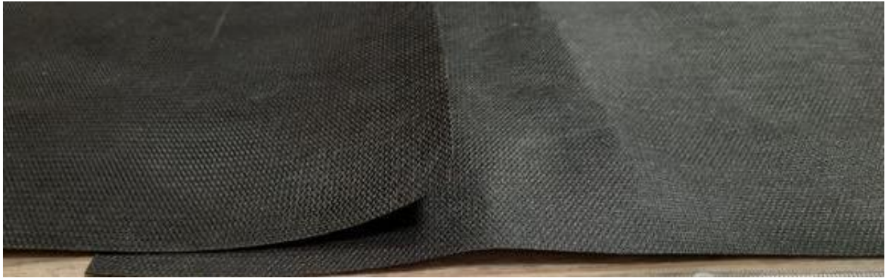
Рисунок 8. – Внешний вид нового токопроводящего материала Контролит СП, уложенного внахлест
