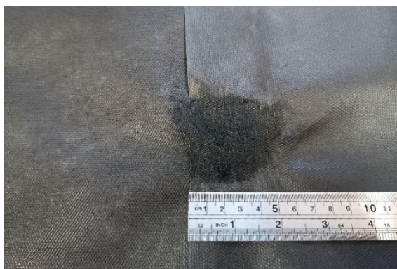
Рисунок 1 – Сварное соединение материала Контролит марки СП
